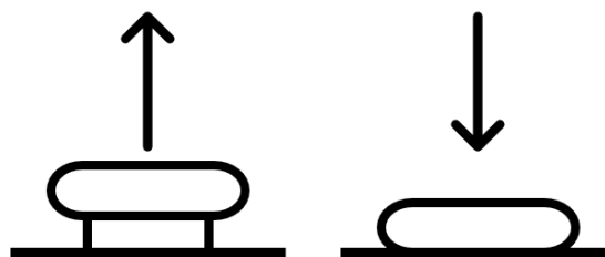
FitGo-systemet består av en vridbar knapp. När ryggstödet ska justeras dras knappen ut och vrids för att släcka eller spänna ryggstödet. Tryck in knappen för att låsa funktionen.
