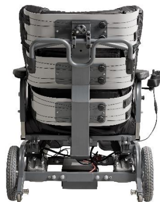
Buede ryggplader, der støtter og omfavner brugeren fra bagdel til nakke.
